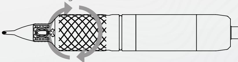
A exposição alterna de 0 à 5 mm conforme regulagem do grip.
